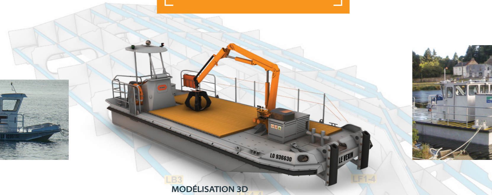
DE PEN A PEN Chaland en aluminium de transport de 12 passagers. Equipé de 2 moteurs SUZUKI 40CV avec barre hydraulique. 1 taué et un portique moteur. 9x3m
