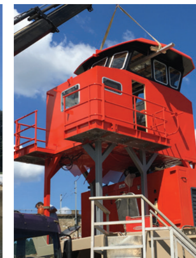
TUYUYU Construction d'un navire de transport de véhicules et de marchandises en acier. Equipé d'un moteur IVECO de 510 CV. 24x10m
