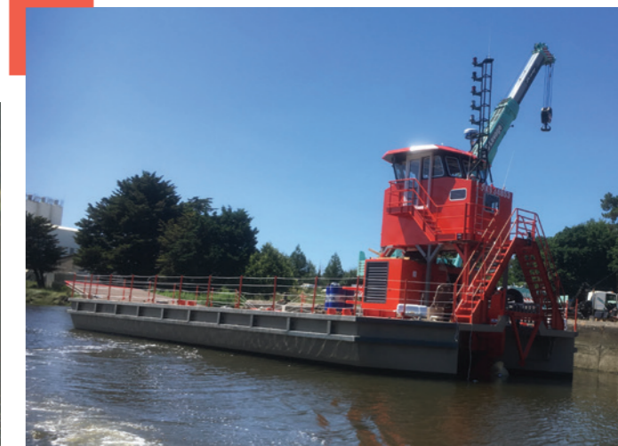
TUYUYU Construction d'un navire de transport de véhicules et de marchandises en acier. Equipé d'un moteur IVECO de 510 CV. 24x10m
