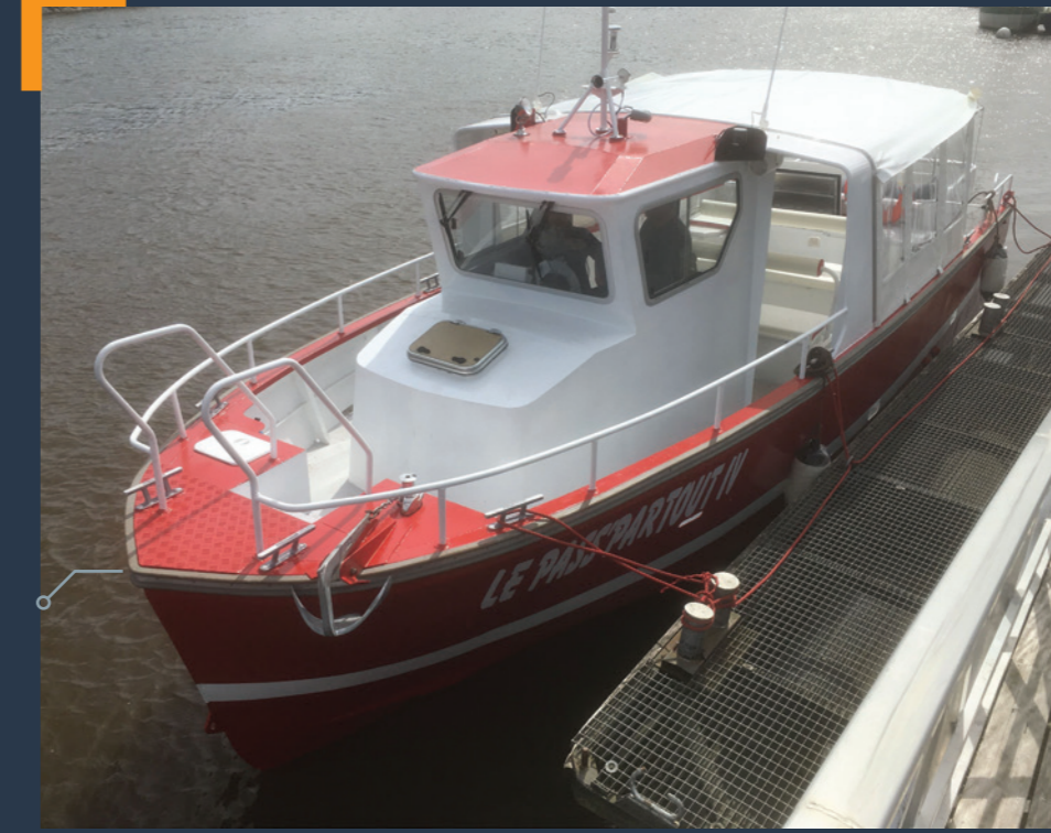
PASS PARTOUT IV Construction d'un bateau en aluminium de 12 passagers destiné à la Corse. 2 moteurs hors bord YAMAHA de 250CV. 10x3,15m
