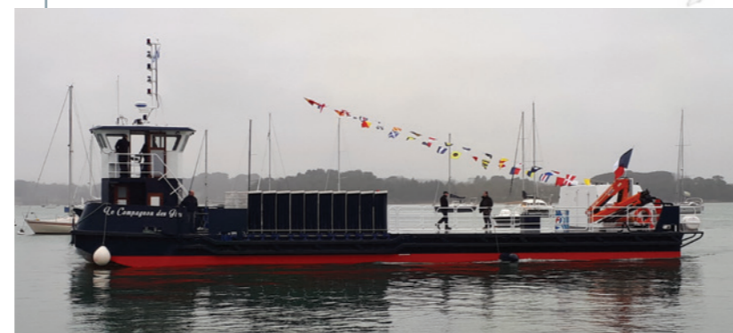
LE COMPAGNON DES ÎLES Construction d'un navire de transport de véhicules et de marchandises autopropulsé. Moteur marin SCANIA 400CV. Propulsion hydraulique. 24x8,20m
