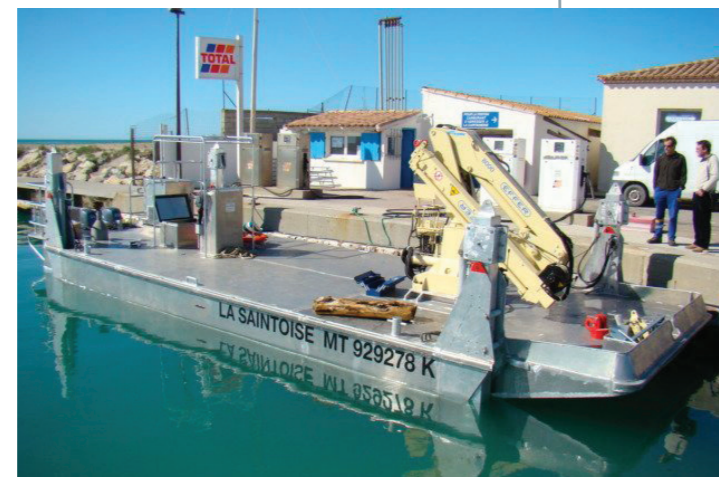
LA SAINTOISE Fabrication d'une barge de travail en aluminium sur 4 pieux de maintien d'une longueur de 5m. Barge équipée de vérins de manœuvre, de 2 moteurs 60CV, d'une grue hydraulique MARINE EIFFER 8T/m et d'un treuil de levage de 1 000 kg. 11x4m
