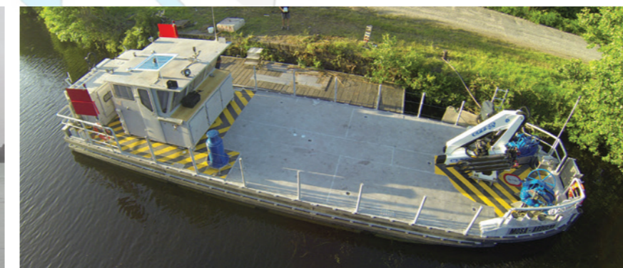
MOSA ARDUENNA Ponton multifonction aluminium livré pour les VNF Nancy. Equipé d'un moteur PERKINS M190C et d'une grue EIFFER 85M. 18,2x4,82m
