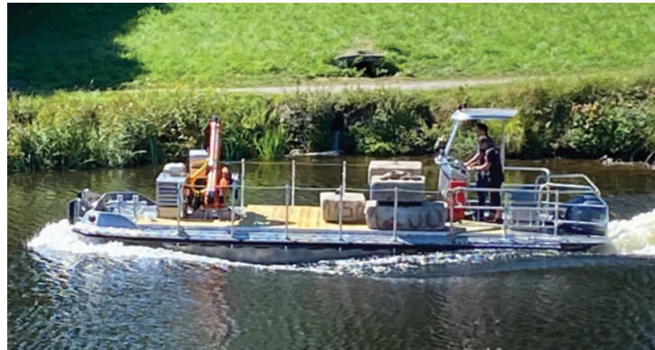
LE VEXIN Barge de travail destinée à BOUYGUES TP. Barge aluminium de 9x3,50 m équipée de 2 moteurs H.B YAMAHA 80 CV et d'une grue 3.5 T/m.
