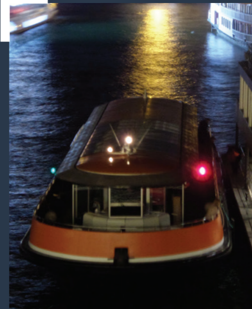
L'INSOLITE Construction d'une navette fluviale en acier destinée au transport de passagers sur la Seine. Superstructure en aluminium. 2 moteurs SCANIA 280CV. 28,80x7,60m
