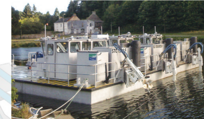
VOIES NAVIGABLES DE FRANCE Construction de 3 barges multifonctions en aluminium, 17m, 14m et 12,50m équipés de moteurs MARINS PERKINS 185 CV. Grue marine EIFFER 8T/m. Propulsion Hydro Armor.
