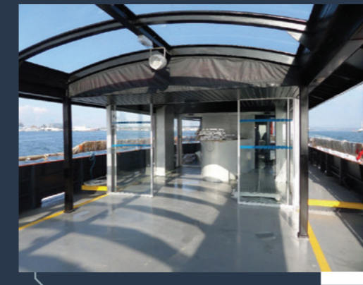
L'INSOLITE Construction d'une navette fluviale en acier destinée au transport de passagers sur la Seine. Superstructure en aluminium. 2 moteurs SCANIA 280CV. 28,80x7,60m
