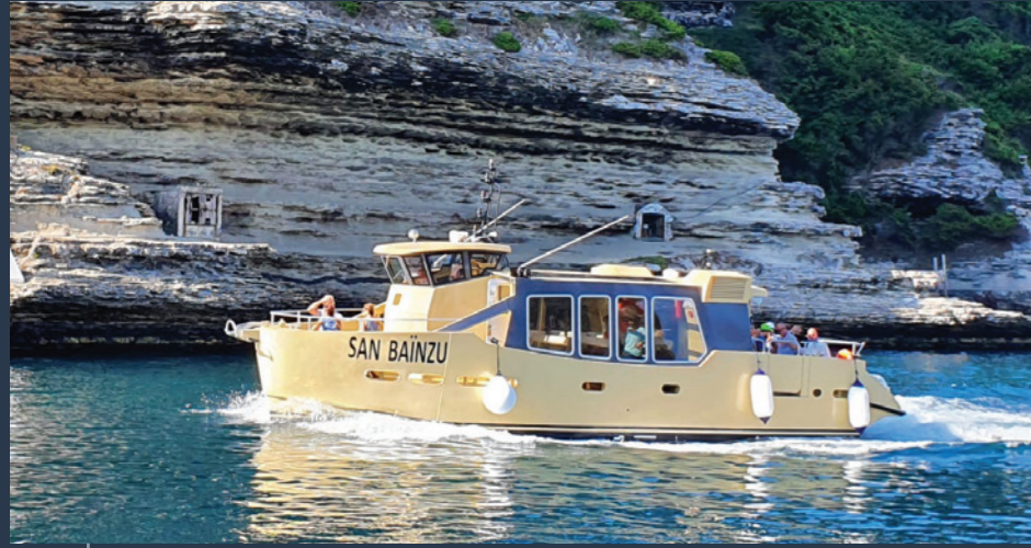
LE SAN BAINZU Destiné à la Corse et livré pour le compte de la société ROCCA NAVIGATION. Bateau aluminium de 12,70 m Hors Tout x 3,98 m propulsé par 2 moteurs CUMMINS 350 CV.
