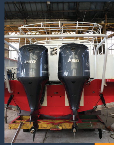
PASS PARTOUT IV Construction d'un bateau en aluminium de 12 passagers destiné à la Corse. 2 moteurs hors bord YAMAHA de 250CV. 10x3,15m
