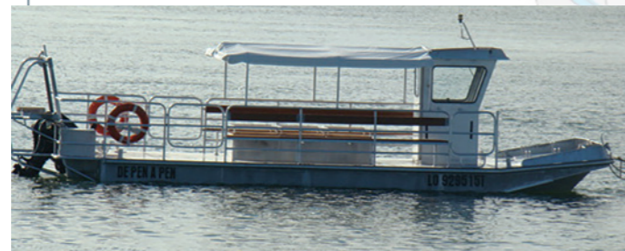
DE PEN A PEN Chaland en aluminium de transport de 12 passagers. Equipé de 2 moteurs SUZUKI 40CV avec barre hydraulique. 1 taué et un portique moteur. 9x3m
